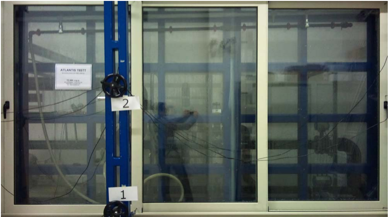
Foto 4: Campione durante la prova di resistenza al carico del vento (prova di deformazione)
